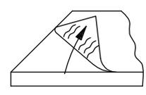
Bei Hochglanz-Fronten bitte erst die Schutzfolie entfernen und dann den Griff montieren!
