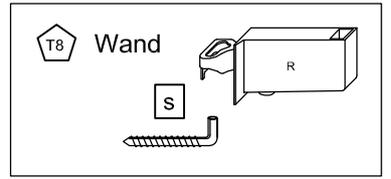
**T6** Die Schrankaufhänger dienen zur Kippsicherung des Schrankes und müssen grundsätzlich montiert werden.
