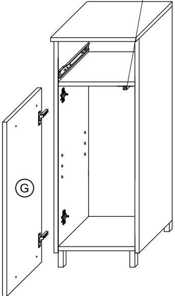
T11 Bei Türmontage das Scharnier einhängen, bis Anschlag öffnen und anschließend festschrauben.
