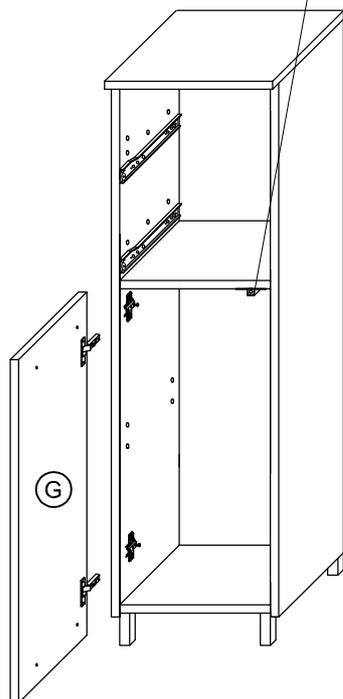
T11 Bei Türmontage das Scharnier einhängen, bis Anschlag öffnen und anschließend festschrauben.
