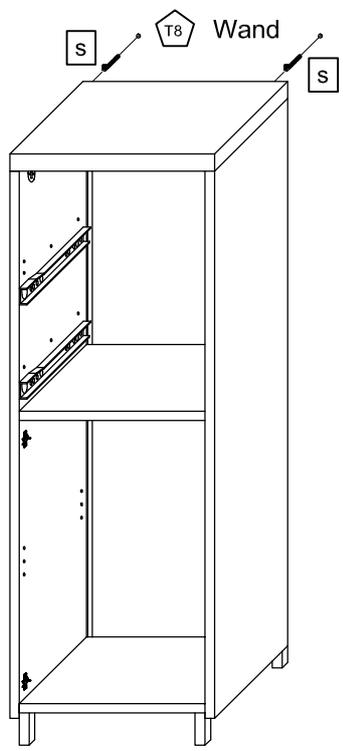
**T6** Die Schrankaufhänger dienen zur Kippsicherung des Schrankes und müssen grundsätzlich montiert werden.
