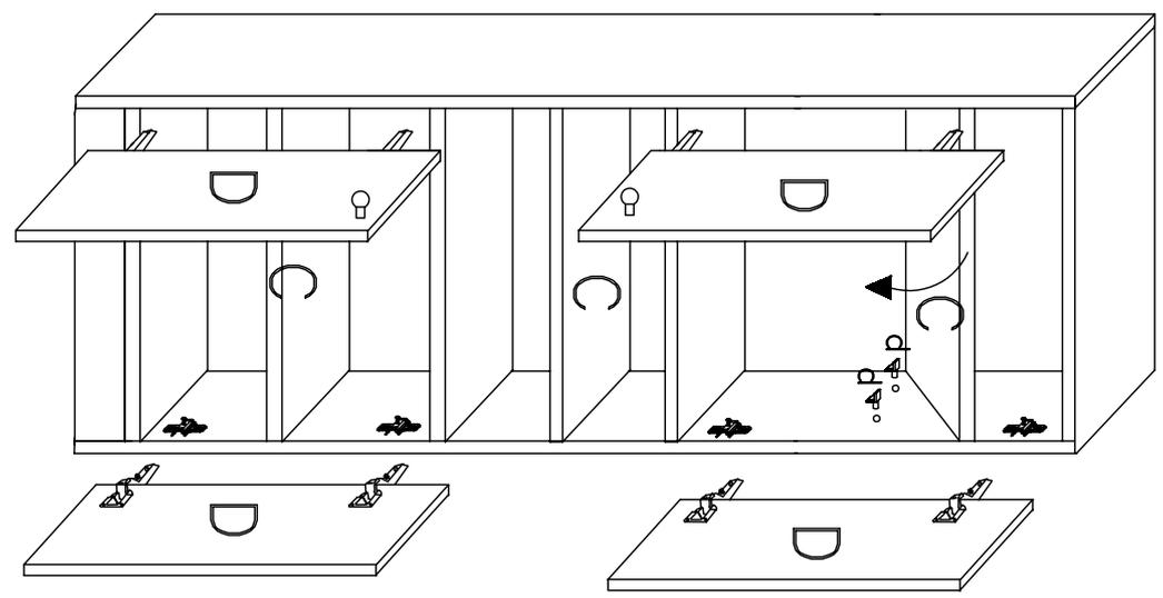
⚠ Bei Türmontage das Scharnier einhängen, bis Anschlag öffnen und anschließend festschrauben.
