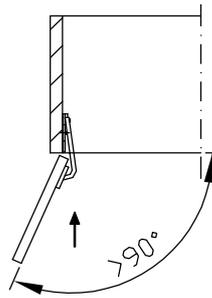
T11 Bei Türmontage das Scharnier einhängen, bis Anschlag öffnen und anschließend festschrauben.
