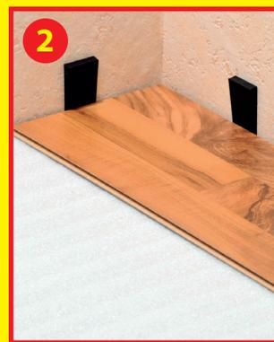
**2** Beginnen Sie die Verlegung in einer linken Raumecke mit der Feder zur Wand. Schneiden Sie diese Feder ab, um eine feste Kante zur Wand zu bekommen. Benutzen Sie Distanzkeile, um eine Dehnfuge von ca. 10-15 mm zur Wand zu erhalten.
