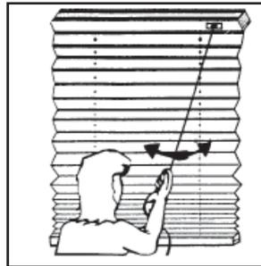
Die Plisseeanlage hat eine Pendelsicherung. Nach links: lösen. Nach rechts: feststellen.
