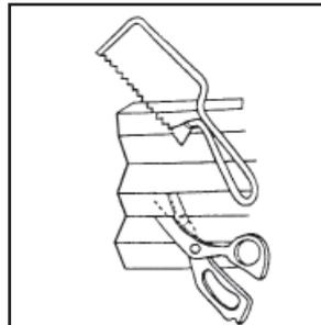
Die Plisseeanlage können Sie kürzen. Die Führungsschiene mit einer Säge kürzen. Die Plisseeanlage können Sie mit einer Schere kürzen.
