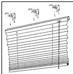
Je nach Länge der Plisseeanlage benötigen Sie 2 oder 3 Träger. Die benötigte Anzahl liegt bei.
