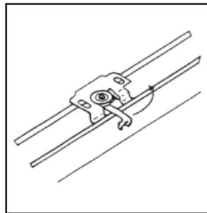
Verschließen Sie die Bügel der Träger.
