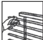
Die Lamellen mit einem Lamellenschneider kürzen.
