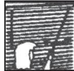
Die Jalousie dadurch nach oben/unten ziehen, dass man die Schnur so weit nach links zieht, bis sie frei von den Rollen ist. Durch das Führen der Schnur nach rechts erneut verriegeln. Zur Verlängerung der Lebensdauer der Schnur die Lamellen waagrecht halten.
