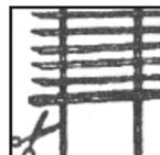
Soll die Jalousie in der Länge gekürzt werden, müssen zunächst die Pfropfen aus der Unterschiene entfernt werden. Anschließend die Schnur lösen. Die Unterschiene sowie die gewünschte Anzahl Lamellen entfernen.
