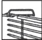
Sollte die Jalousie zu breit sein, müssen Ober- und Unterschiene mit einer Säge bzw. Metallsäge gekürzt werden.
