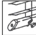
Die Unterschiene in die Leiterkordel einsetzen. Die Schnur erneut befestigen und die überflüssige Leiterkordel bis auf ein bis zwei Stufen abschneiden. Schnur und Leiterkordel wieder in die Unterschiene einfädeln und die Pfropfen einsetzen.
