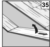
Für Heizungsrohre müssen Lochbohrungen, die 3 cm größer sind als der Rohrdurchmesser, ausgespart werden. "Einpassstück" aussägen, beleimen, einpassen und mit einem Keil bis zur Aushärtung des Leimes fixieren. Anschließend Aussparungen mit Heizkörpermanschetten verkleiden [23, 24, 25].
