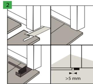
Dilatationen entlang den Wänden sollen mit passenden anhand von Klebstoff oder Klips montierten Sockelleisten zugedeckt werden. Wir empfehlen unsere Sockelleisten von Afirmax, die zu einzelnen Designbodendeckern passen und stoß- und kratzbeständig sind.
