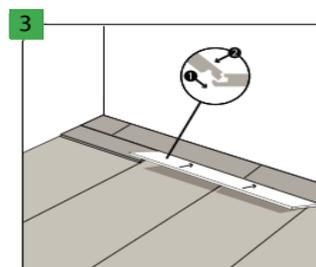
Die Afirmax-Bodenpaneele werden mit den Verschlüssen, die auf der kurzen und der langen Kante zu verbinden sind, versehen. Zuerst müssen die langen Kanten der Paneele miteinander verbunden werden. Dafür ist die lange Paneelekante in die früher verlegte Paneele Reihe einzuschieben. Verschieben Sie das Paneel bis zum Winkel, lassen Sie einen kleinen Abstand.
