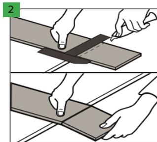
Verwenden Sie zum Zuschneiden der Bodenpaneele ein scharfes Messer, schneiden Sie die obere Schicht ein, danach knicken Sie energisch das Paneel nach unten weg. Die Bodenpaneele können auch mit einer elektrischen Säge zugeschnitten werden.
