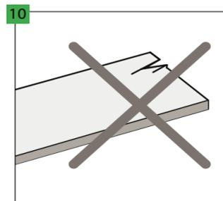
Vor und während der Verlegung sind eingehend auf Beschädigungen und Materialfehler zu überprüfen. Paneele mit sichtbaren Mängeln oder Beschädigungen dürfen nicht verlegt werden.
