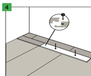
Senken Sie danach das Paneel so ab, um die kurze Kante verriegeln zu können, klopfen Sie vorsichtig das Paneel ein. Beginnen Sie in der Ecke des Raumes. Der Verschluss auf der kurzen Kante ist mit einer speziellen Verriegelung versehen, die bei der richtigen Verlegung eingeschlossen wird. Beim Verlegen darf kein Druck ausgeübt werden! Wenn Schwierigkeiten bei der Paneeleabsenkung bzw. Verriegelung entstehen, ist der Abstand im Verschluss zu vergrößern und das Paneel noch einmal abzusenken.
