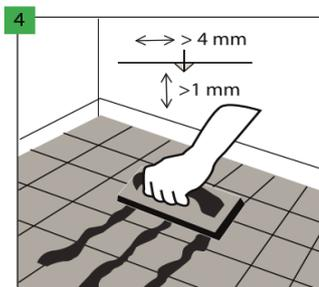
Bei der Verlegung auf keramischen Fliesen soll die Fugenbreite nicht mehr als 4 mm und die Tiefe nicht mehr als 1 mm betragen. Größere Abstände sind mit Harzmasse auszufüllen.
