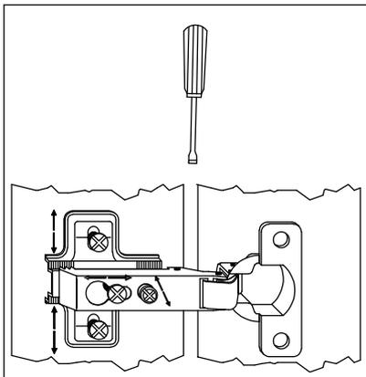
T11 Bei Türmontage das Scharnier einhängen, bis Anschlag öffnen und anschließend festschrauben.
